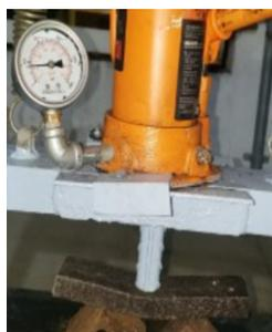
**Figura 2** Muestra de PP (95%) + Lirio (5%) siendo sometida a la prueba de Flexión.
