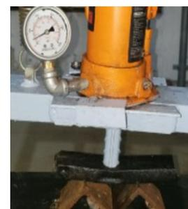
**Figura 3** Muestra de PP (75%) + Lirio (25%) siendo sometida a la prueba de Flexión.
