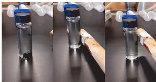
Figura 3.9 Prueba de manipulación magnética utilizando un imán convencional se observa como el material con NPs de Ni es atraído asía el imán.
