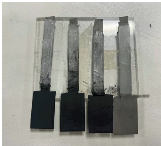
Figura 3. Comparación de cátodos con recubrimiento de nanotubos de carbono con magnetita y el sustrato de titanio.
