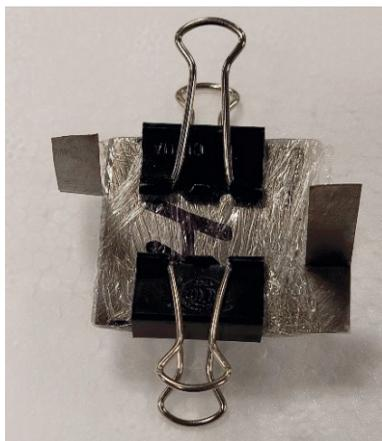
**Figura 1.** Capacitor con base en tinta de biocarbón activado.
